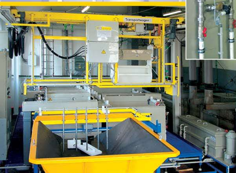
GALFA Industriegalvanik GmbH, Finsterwalde Zink-Phosphatier-Trommelautomat
